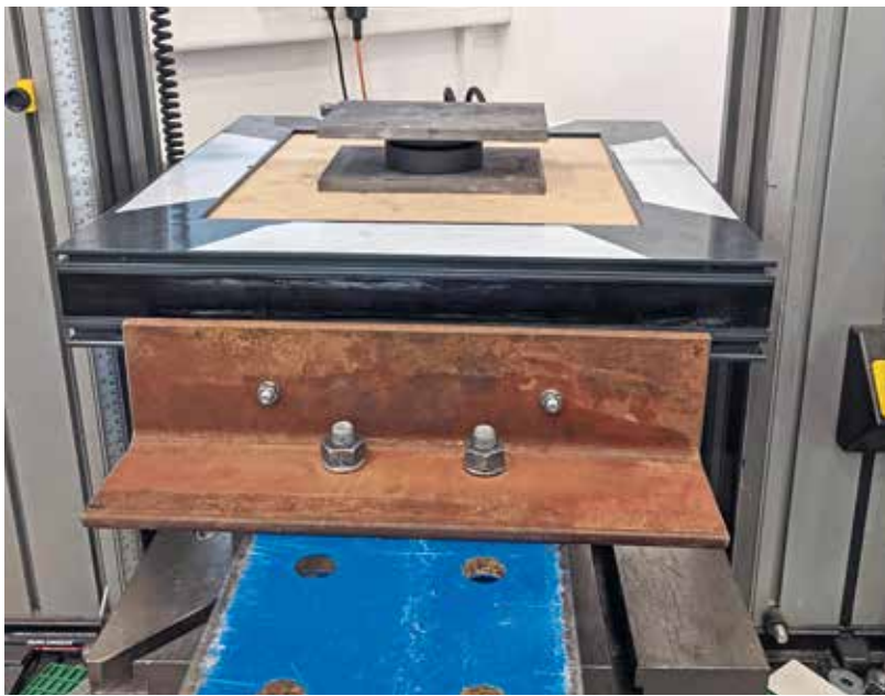
Prüfaufbau der Fensterlaschen an einem kompletten Fensterrahmen.
