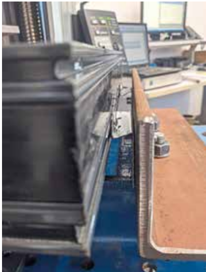
Bauteilprüfung: Versagensfall der Fensterlasche – Biegung infolge von Querlast.
